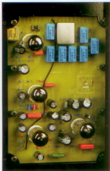
Eine Verstärkerplatte, ein Kanal: Im FTP stecken zwei dieser Leiterplatten, dazwischen residiert das Netzteil
