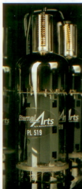
Die Fernsehröhre PL519 kommt nochmal zu neuen Ehren: Entsprechend verschaltet, kann man offensichtlich hervorragende Verstärker damit bauen
