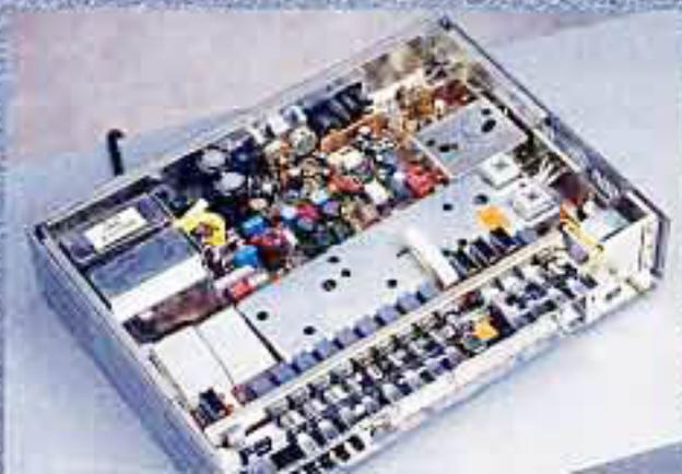
Hochselektive Vierfach-Keramikschwinger beschenken dem Tuner eine extrem gute Trennschärfe. Er hat ein Mischteil mit Gegentaktabstimmung durch Kapazitätsdioden und einen abgestimmten Eingangskreis. Sieben Stationen lassen sich fest programmieren; eine pfliffige Ratio-Mitte-Mimik, genannt Tunoscope, macht das Abstimmen und Übernehmen von Sendern in den Speicher einfach und präzise.
