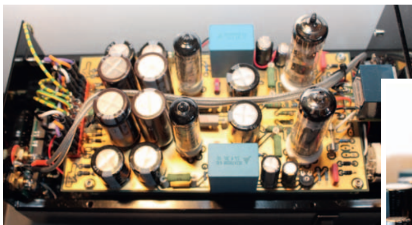
Zweistöckig: Der vergossene Netztrafo sitzt quasi im „Keller“ des Gehäuses.
