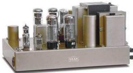
Auch eine Entwicklung der frühen Stereo-Ära: die Röhren-Endstufe LEAK Stereo 60
