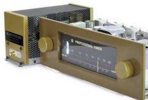
Der Schweizer Radiospezialist Gabler entwickelte 1960 den wunderschönen kleinen Dynaphon Professional UKW Tuner 62B in Ballempfänger-Qualität (vom Autor mittels Electrohome-MPX-Decoder für Stereo umgerüstet)
