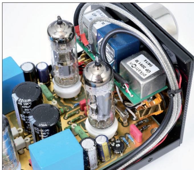
Mit Schutzgas gefüllte Relais schalten das Eingangssignal zwischen Cinch- und XLR-Eingang um. Hinter dem XLR- Eingang folgt ein Übertrager zur Desymmetrierung, bevor es zum Pegelsteller geht.
