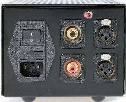
Der Eingangsumschalter auf der Rückseite des Kopfhörerverstärkers wirkt nicht simpel direkt, sondern betätigt Relais.
