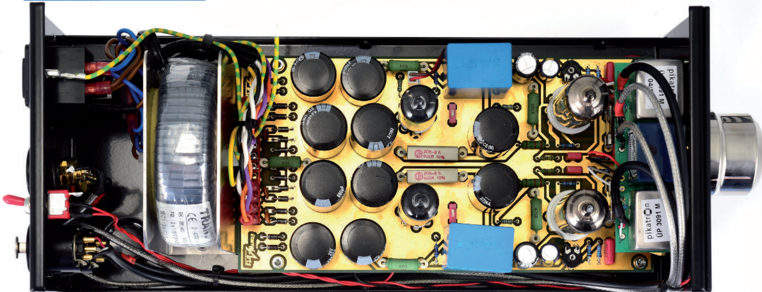
70 Mikrometer dick vergoldete Leiterbahnen sind ein Anblick, der dem High-Endler gefällt. Doch die inneren Werte zählen mehr: speziell gewickelter Trafo mit geringstem Streufeld, selektierte Bauteile, ALPS-Poti, Keramik-Röhrenfassungen und dicke Folienkondensatoren.
