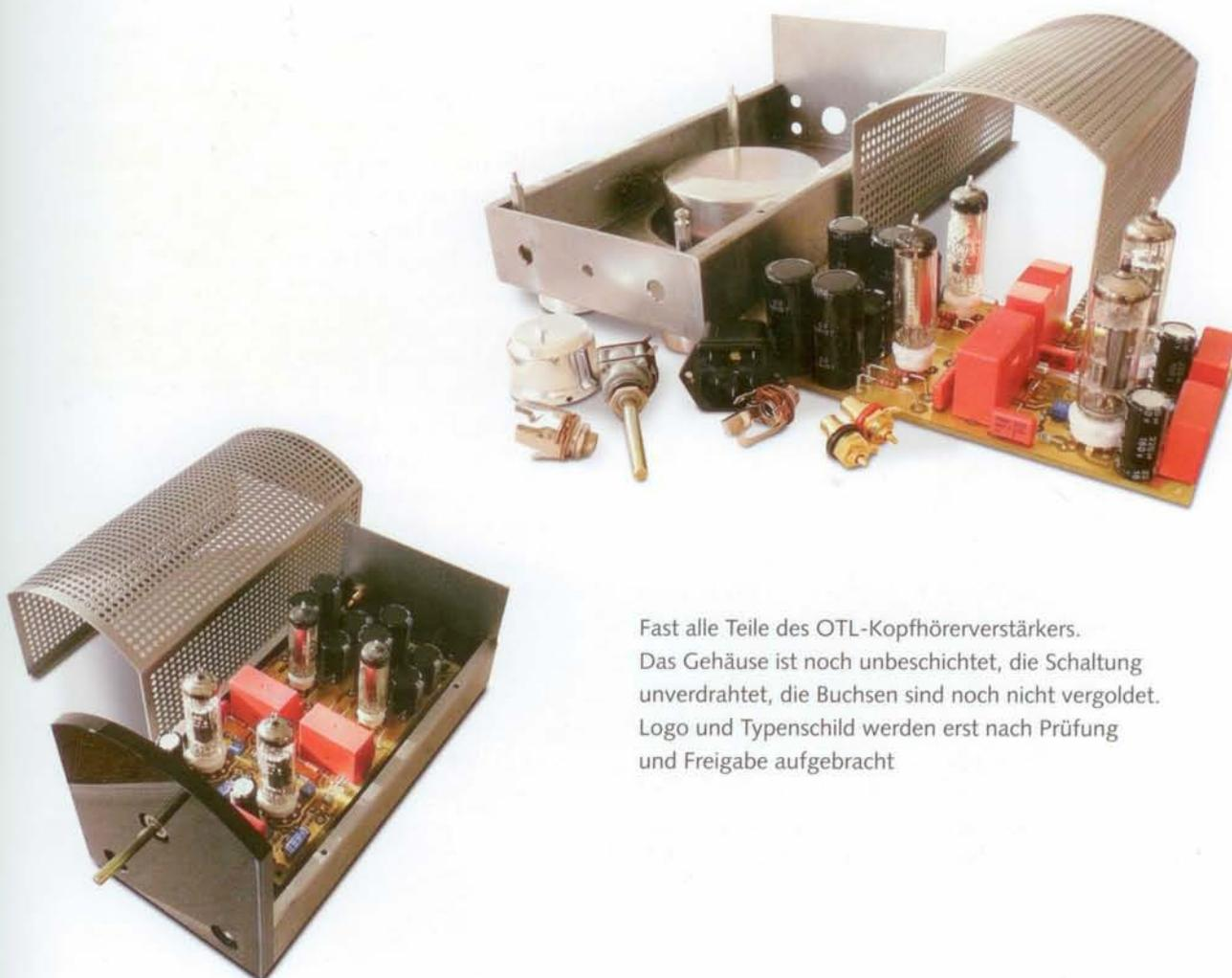
Fast alle Teile des OTL-Kopfhörerverstärkers. Das Gehäuse ist noch unbeschichtet, die Schaltung unverdrahtet, die Buchsen sind noch nicht vergoldet. Logo und Typenschild werden erst nach Prüfung und Freigabe aufgebracht
