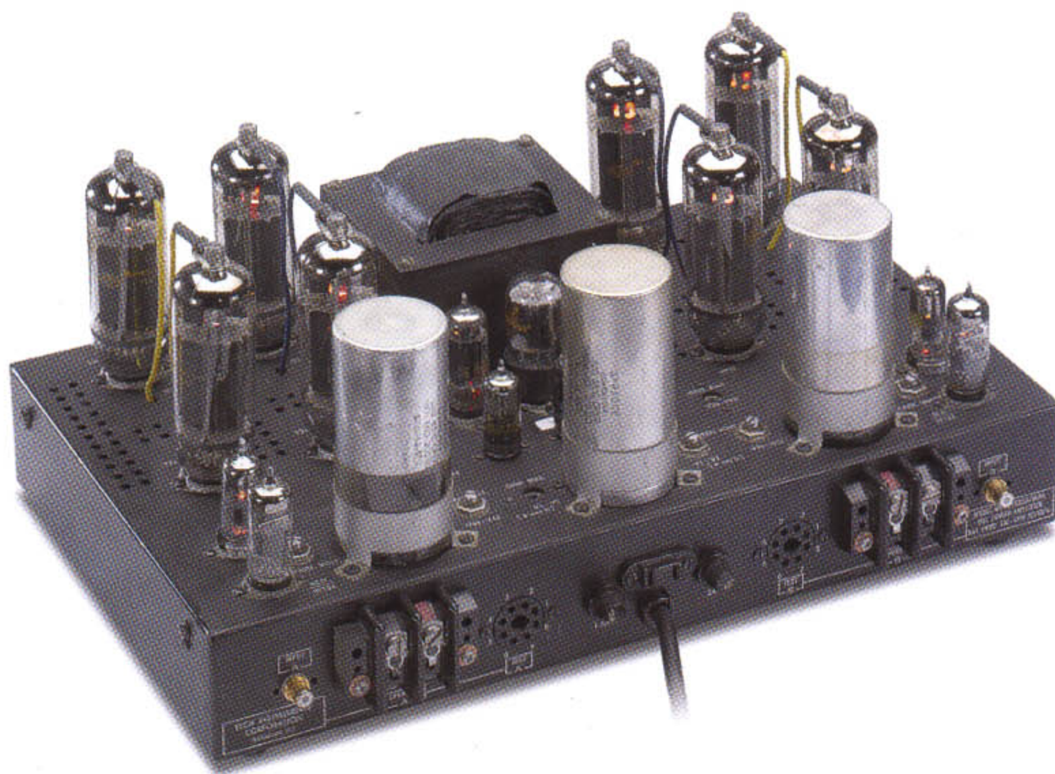
Die Tech Instruments Corp. baute unter Futterman-Lizenz diese H-3 (Leistung: 40 Watt an 16 Ohm). Der Amp wurde im Juli 1974 von Julius Futterman persönlich modifiziert und 2008 von Bob Hovland restauriert
