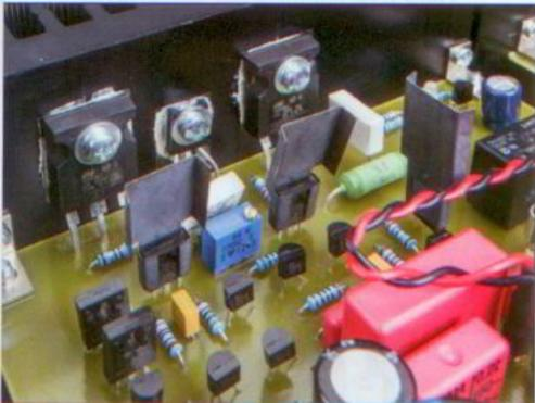
Zwei bipolare Endtransistor-klassiker besorgen die Ausgangsleistung der Endstufe
