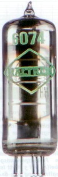
Bei dieser Röhre handelt es sich um einen Spannungsstabilisator, der im Betrieb außerdem sehr dekorativ leuchtet
