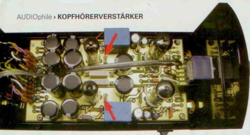
**SYMMETRIE:** Von der Spannungsversorgung bis hin zur Ausgangsbuchse sind die beiden Kanäle parallel aufgebaut. In der Mitte: die beiden Umschalter (Pfeile) für 300- oder 20-Ohm-Kopfhörer, die sich auch von außen durch die Gitterabdeckung erreichen lassen – der Deckel kann also draufbleiben.
