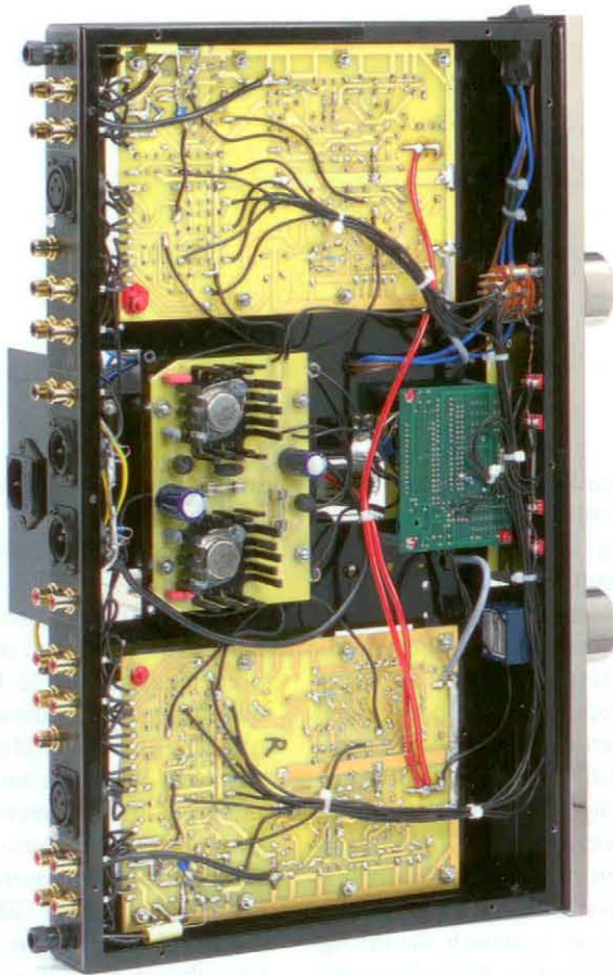
Um die sanft hochlaufende Heizspannung kümmern sich natürlich Halbleiter. Auf den Platinen sind alle Kupferbahnen vergoldet
