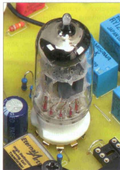
Keramische Röhrenfassungen, selektierte Übertrager (links)
