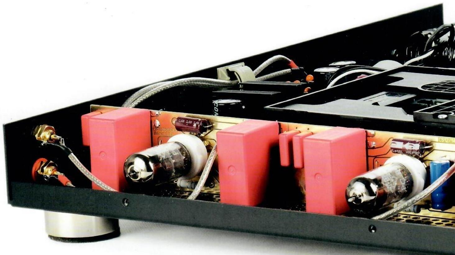
Zwei Telefunken-PC86-Trioden in Kathodenfolgeschaltung machen den besonderen EternalArts-Klang aus. Die Röhren-Ausgangsstufe entspricht der des erheblich teureren CD-Players DP.
