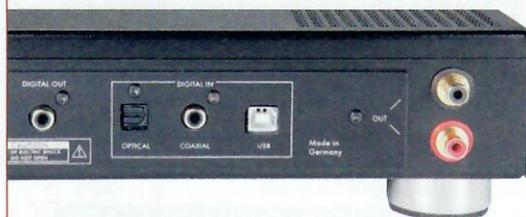
**Die stabilen Cinch-Buchsen des Analogausgangs sind fest mit der Rückwand verschraubt. Daneben sitzen die digitalen Ein- und Ausgänge.**
