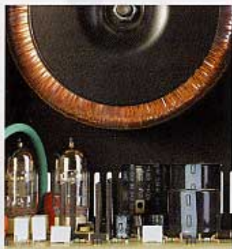
Potent: Ein Blick in den offenen FT A70 zeigt den mächtigen Ringkern-Trafo, der die beiden ansonsten strikt getrennten Platinen für den rechten und linken Kanal versorgt.
