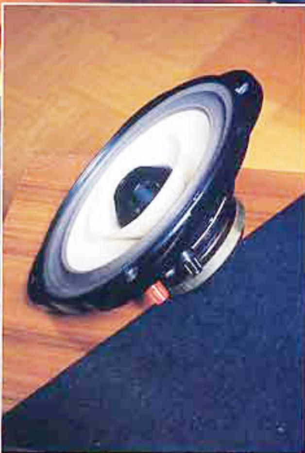
Das derzeitige Spitzenchassis: DX 4. Seltene-Erden-Magnet, einmaliger Schwingspulen-Aufwand (Paplering, auf den und in den jeweils eine Spule gewickelt ist). Ein besseres Verhältnis zwischen Magnetfluss und Membranmasse hat kein anderer Lautsprecher (2,4 Tesla Kraftliniendichte). Um neue und egal wie alte Lowthers kümmert sich in Deutschland Opera Audio in Karlsruhe (Telefon 0721/9665402, [www.operaaudio.de](http://www.operaaudio.de)) genauso sachverständig wie liebevoll.
