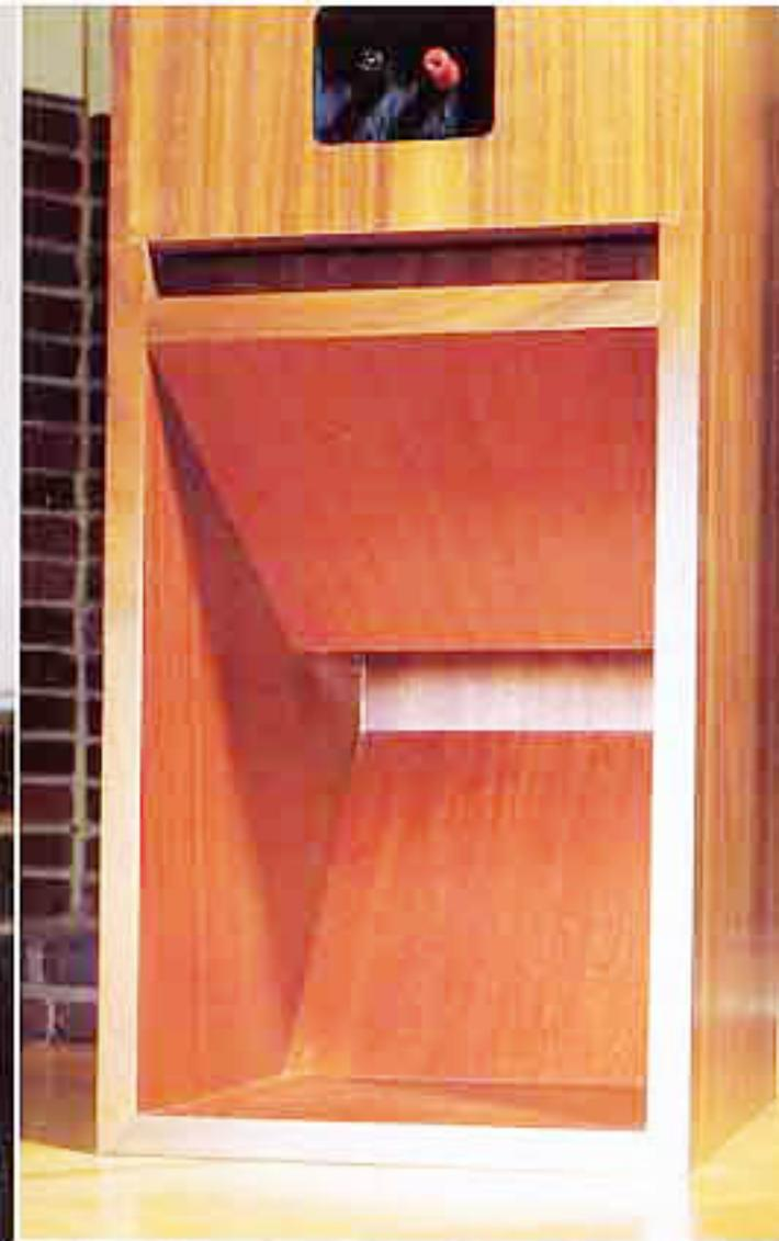
Die rückwärtigen Schallanteile beider Chassis werden gleichzeitig dem Hornmund zugeführt und treten sodann im Rücken der Box aus. Oberhalb des Hornendes befindet sich die Druckausgleichsöffnung eines separat gezogenen Schachtsystems, das Bicos heißt und stehende Wellen verhindert.
