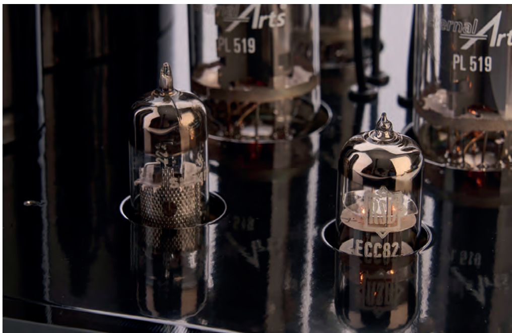
Vorne links zu sehen ist die Röhre der Eingangsstufe, eine kleine EF 184 Pentode von Siemens. Vorne rechts befindet sich die kleine Doppeltriode ECC82 von RSD, die als Treiberstufe fungiert
