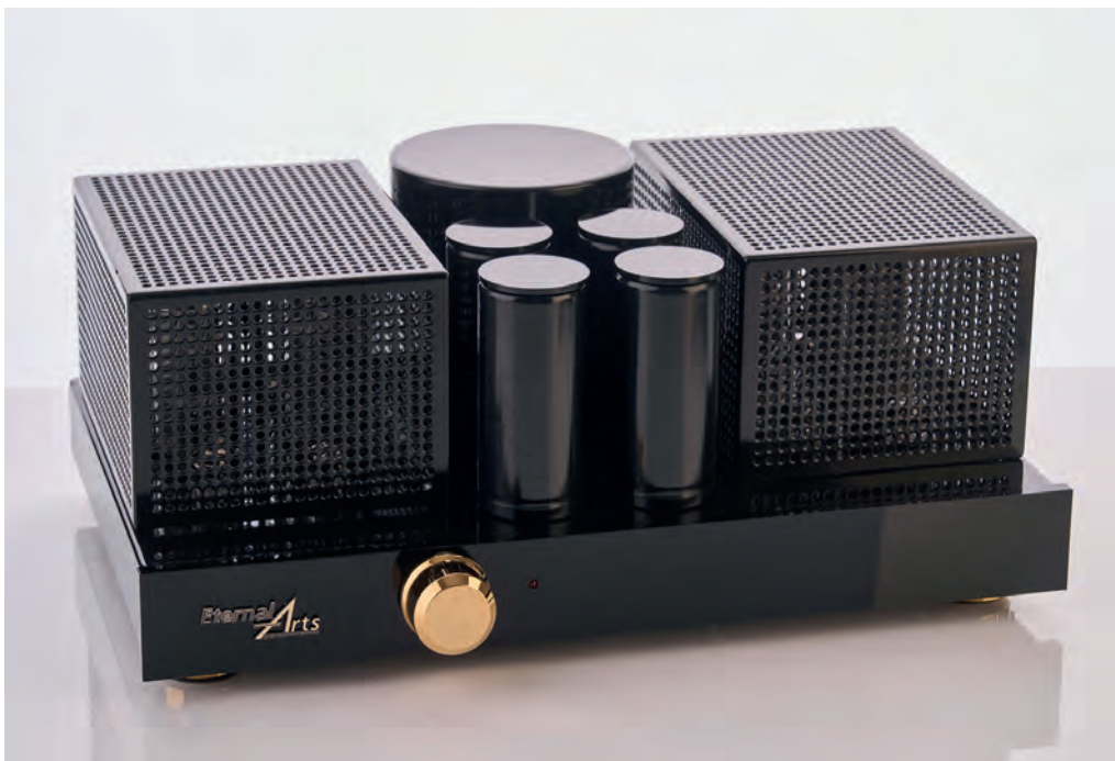
Auch mit Röhrenabdeckungen macht die Endstufe optisch eine sehr gute Figur. Es fällt dennoch sofort auf, dass hier die üblicherweise großen Ausgangsübertrager „fehlen“. Der goldene Knopf auf der Front ist der Ein-/Ausschalter
