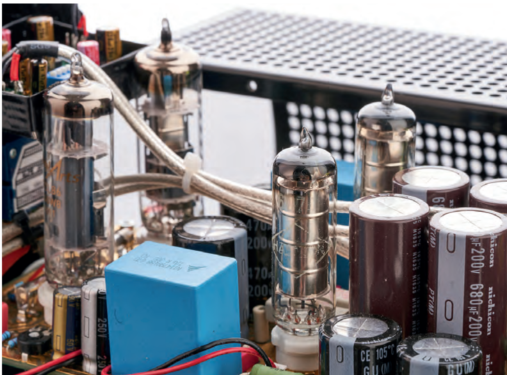
Im Betrieb leuchtet die Stabilisator-Röhre 6074 (hier eine NOS-Type von Haltron) durch ionisiertes Neon-Gas lila-orange
