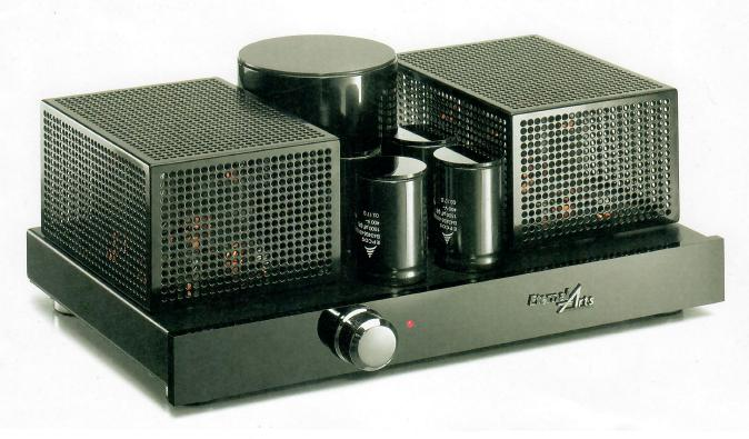
ein Flitzebogen, als sich ein Test der Röhrenendstufe Eternal Arts OTL Mk III mitsamt Line-Vorstufe ankündigte: Beide Geräte sind in OTL-Technik ("output transformerless", ohne Ausgangstrafos) aufgebaut und bieten dadurch Anstiegszeiten weit jenseits dessen, was man von anderen Verstärkern gewohnt ist.
