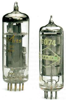
Die HLP Vorstufe ist komplett mit NOS Röhren aufgebaut -Tube Rolling erübrigt sich hier! Die PCL86 links ist eine Verbundröhre, die ein Trioden- und ein Penthodensystem in ihrem Glaskolben trägt. Derlei Röhren waren früher in Radios sehr beliebt, konnte man doch eine Eingangssektion zusammen mit einer Treiberstufe extrem platzsparend realisieren
